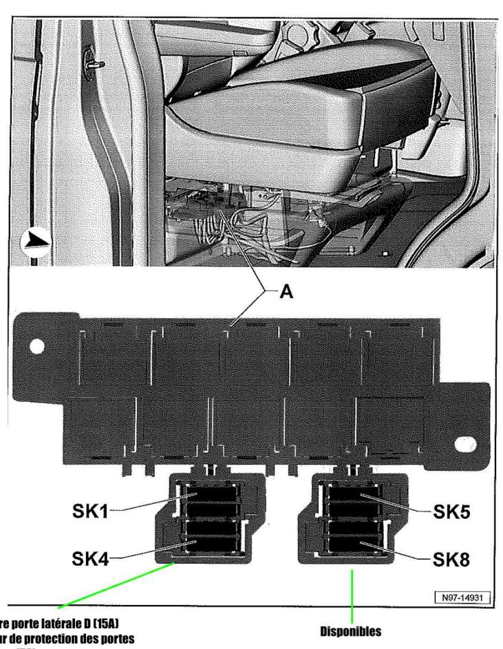
1. Cal d'aide fermeture porte latérale D (15A) 2./4: Cal de transmetteur de protection des portes
