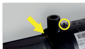
Commencer la soudure. Effectuer les contrôles nécessaires (alignement, profondeur d'insertion et indicateurs de fusion).
