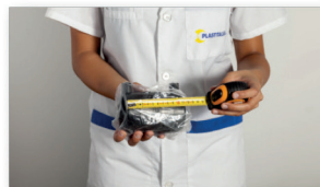
Controllare le dimensioni degli elementi da saldare.
