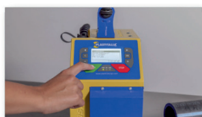
Commencer la soudure. Effectuer les contrôles nécessaires (alignement, profondeur d'insertion et indicateurs de fusion).
