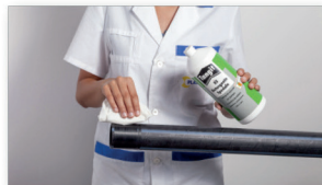
Limpiar las superficies con el detergente idóneo.
