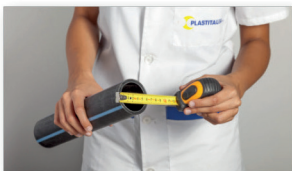
Controllare le dimensioni degli elementi da saldare.
