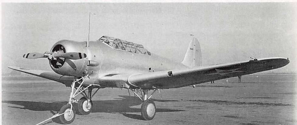
Le dernier BT-1 de série, modifié en octobre 1938 avec un train tricycle fixe, pour des essais de cette forme de train d'atterrissage alors nouvelle.
