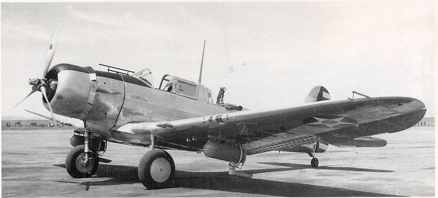
Un Northrop A-17A à train escamotable, avec des pots fumigènes sous les ailes. Les orifices des mitrailleuses d'ailes sont obturés. Bowers
