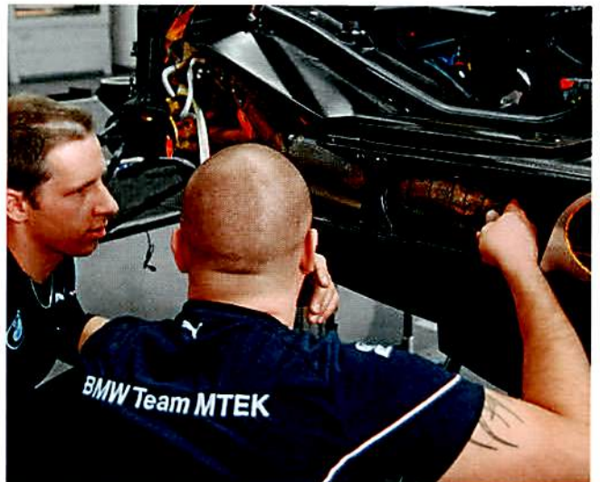
Der Auspuff wird in den Türschweller verlegt. Die Side pipes – je ein Auspufftopf pro Seite – haben den unangenehmen Nebeneffekt, dass sich das Cockpit stark aufheizt
