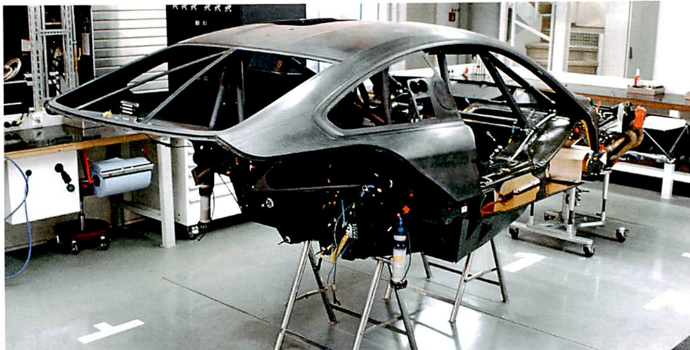
Die Außenhaut der DTM-Autos besteht aus Kohlefaser. Gut zu erkennen sind die v-förmigen, mit dem Monocoque verschraubten Stahlstreben, die dem Getriebe und damit auch der Hinterradaufhängung zusätzliche Stabilität geben
