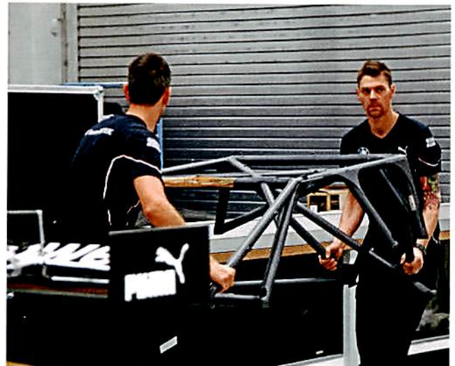
Die Montage des Überrollkäfigs ist einer der ersten Arbeitsschritte beim Aufbau eines DTM-Autos. Auch dieses Fachwerk aus Stahlrohren ist ein Einheitsbauteil
