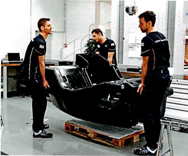
Drei Techniker des BMW-Teams MTEK schleppen das 125 Kilo schwere Kohlefaser-Monocoque in die Werkstatt. Der Benzintank ist in die Sicherheitszelle integriert
