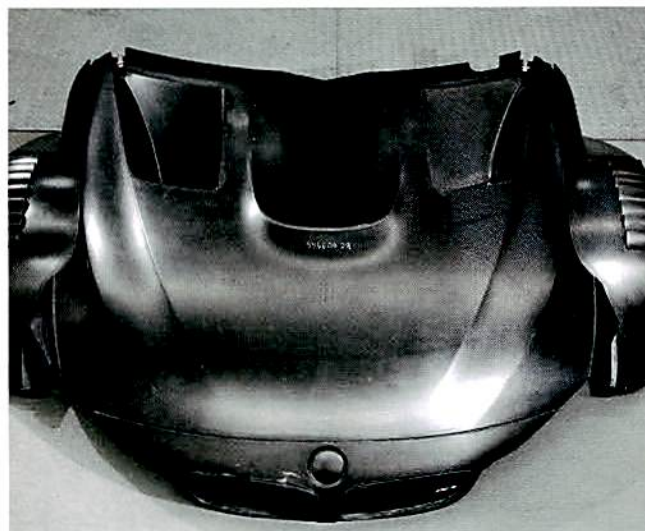
Die Frontpartie besteht aus einem einzigen Kohlefaser-Teil. Die Schnauze des M4 ist in Windeseile montiert – und sie hält inzwischen auch derben Remplern stand
