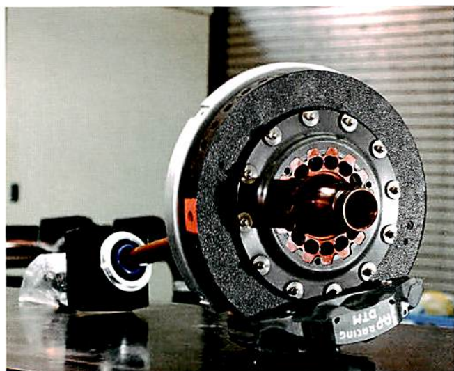
Die Carbon-Bremsscheiben und die Bremssättel liefert AP. Ein Fahrer muss pro Saison mit drei Sätzen Scheiben auskommen. Wasserkühlung ist erlaubt, aber selten notwendig
