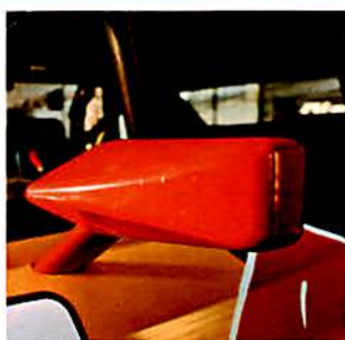
Mattias Ekström und sein Meister-Audi von 2004: Die Reifen waren vergleichsweise schmal. Die Außenspiegel folgten schon dem Diktat der Windschlüpfrigkeit. Der vergleichsweise zierliche Heckflügel war starr montiert
