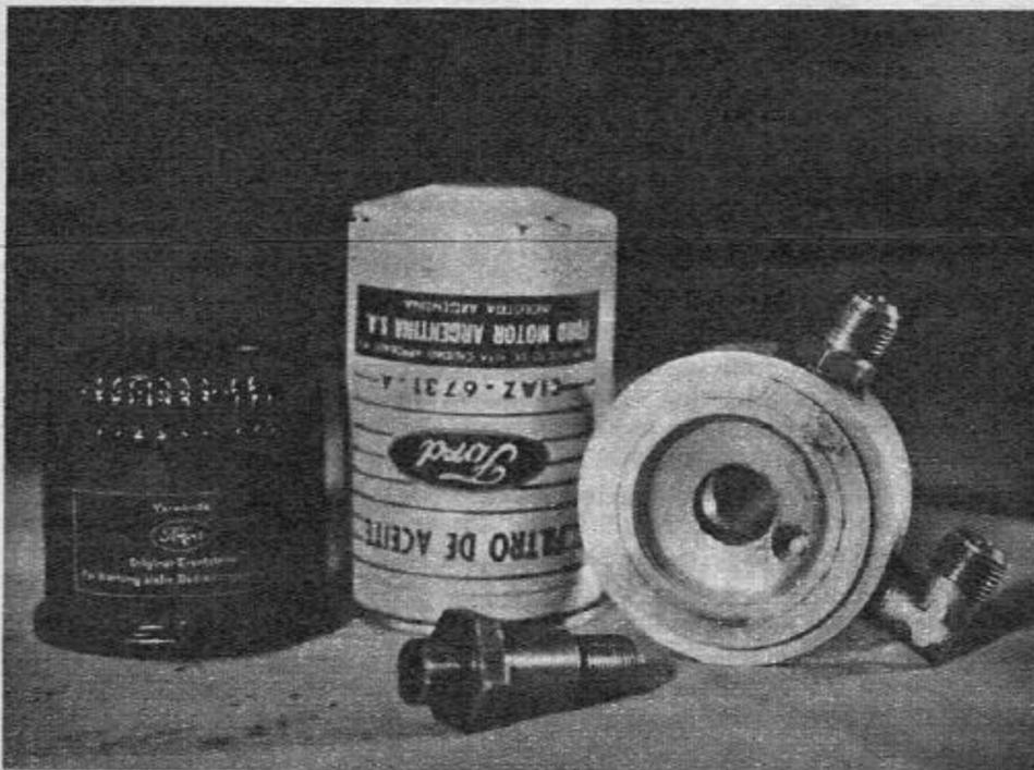
El adaptador para acoplar un radiador de aceite al sistema de lubricación. En el centro un filtro original, y a la izquierda el que debe llevar para compensar la falta de espacio que se crea al colocar este adaptador.
