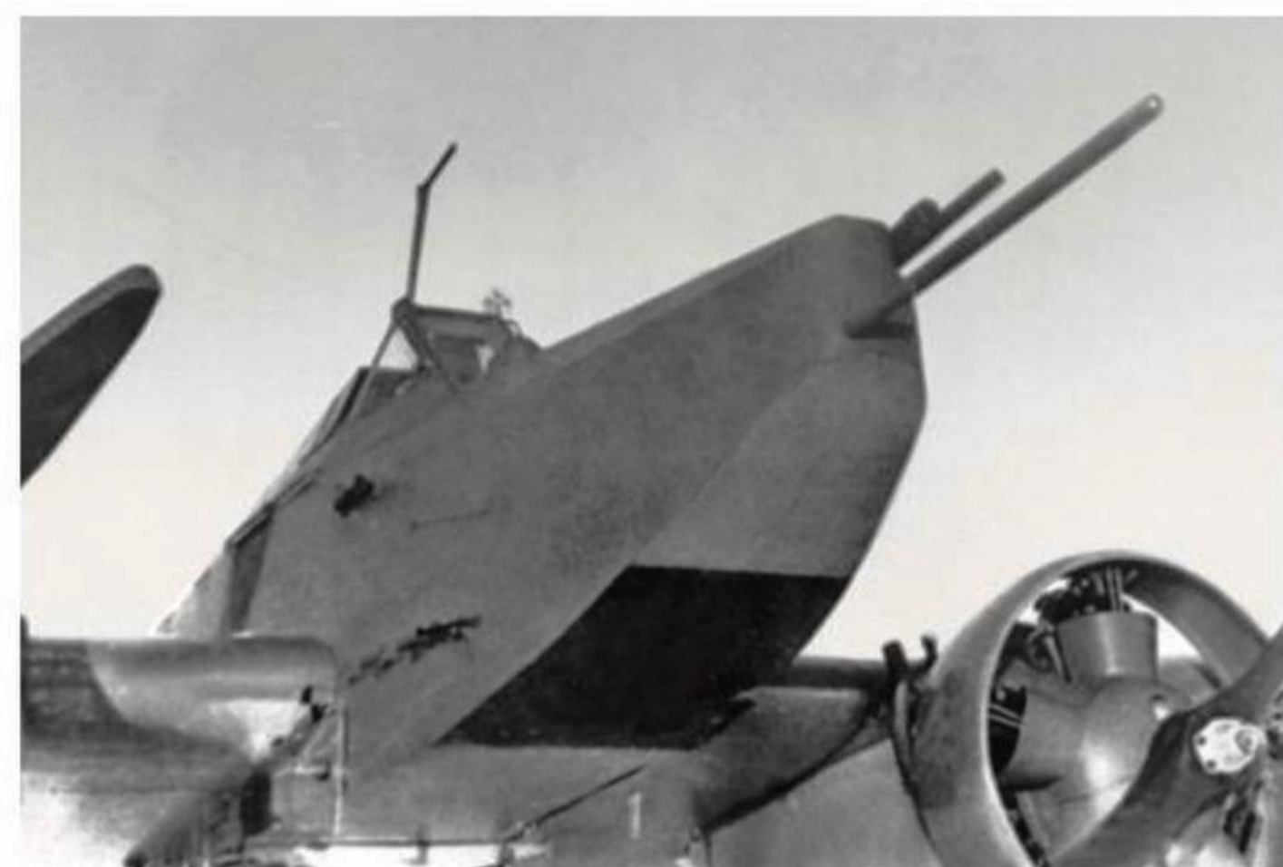
▼ Le nez du Pégase n° 03 avec son canon VYa factice dans le nez. On peut noter le collimateur devant le pare-brise et les moteurs M-11F équipés d'anneaux « Townend ».
