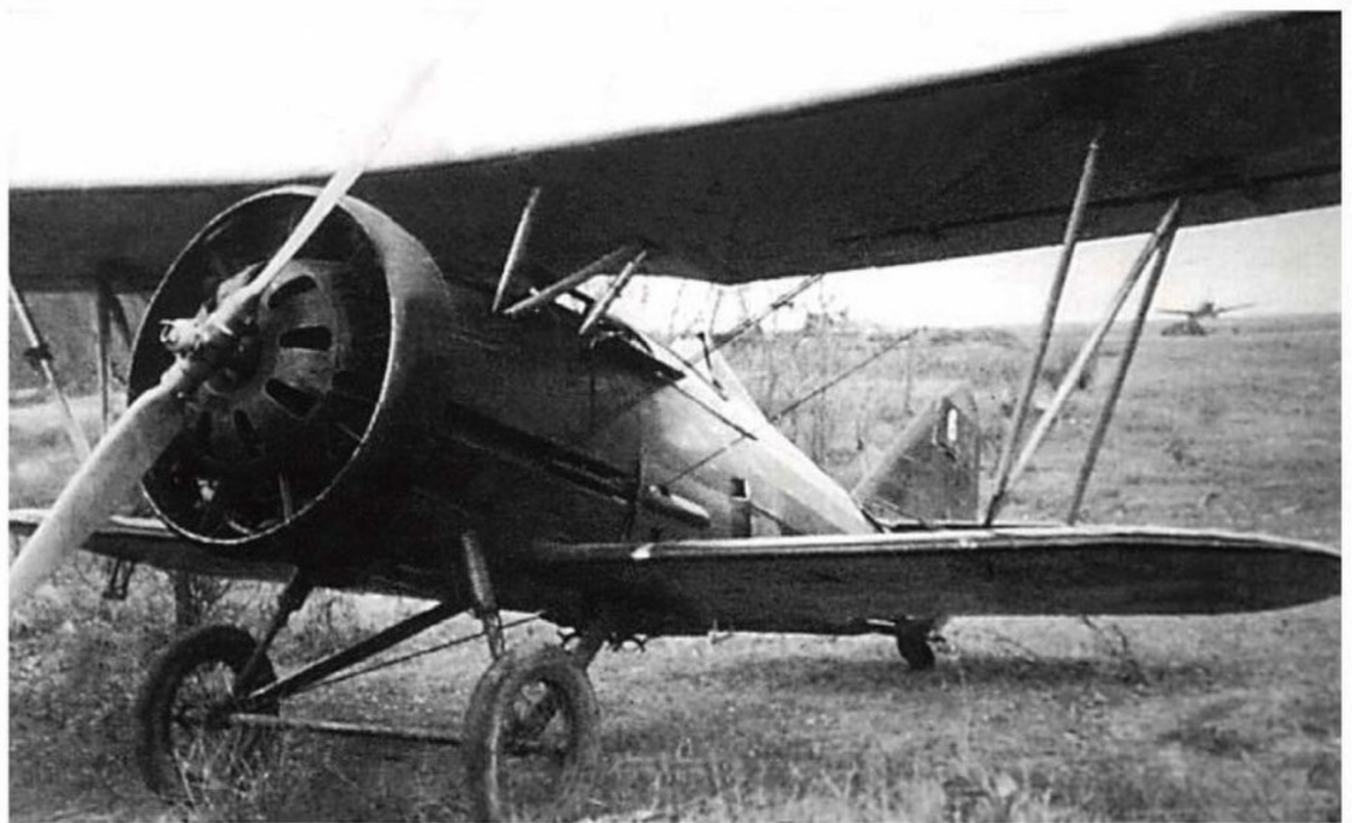
▲ Ci-dessus : Un « antique » chasseur I-5 conçu par Polikarpov au cours de la première moitié des années 1930. Celui-ci a été transformé en bombardier léger, comme en témoignent les lance-bombes sous les plans d'aile basse. (Marmain)
