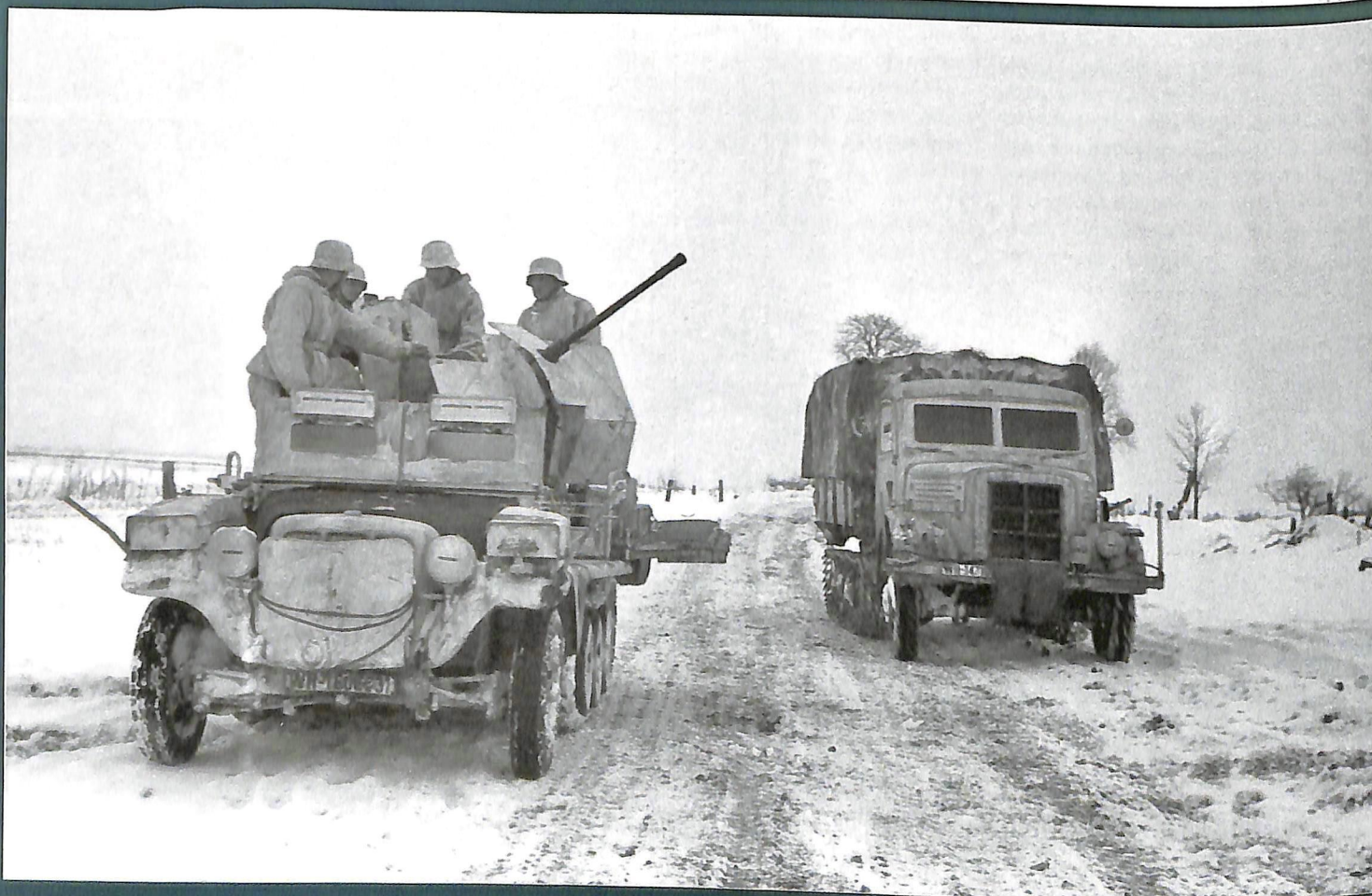
▲ Le fait de monter une pièce de 2cm Flak 38 en lieu et place du modèle 30 est signalé par un changement de nomenclature, l'engin est alors dénommé Sd.Kfz. 10/5. Cette explication est communément admise par nombre d'auteurs, mais n'est confirmée par aucun document officiel connu. Le débattement en site négatif permet à l'engin d'engager des cibles au sol ; dans ce cas, pour offrir une protection améliorée aux servants et aux organes sensibles tels que le radiateur, un blindage partiel est ajouté. Il en existe plusieurs variantes. ECPA-D
