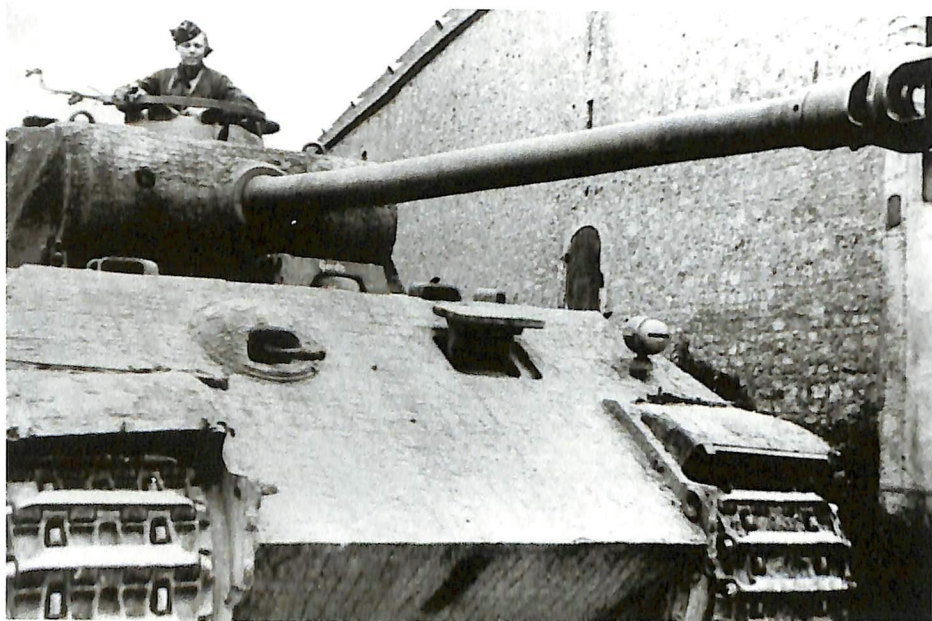
▲ & ▲▲ Panzer V Ausf. A Panther de la Panzer-Lehr-Division (division blindée d'instruction) ou 130. Panzer-Division en Normandie. L' Ausf. A sort des chaînes de production très rapidement après l' Ausf. D afin d'en corriger les défauts les plus graves. La version A du Panther est identifiable à la protection de sa mitrailleuse de caisse et à la présence d'une trappe de vision frontale dans le glacis. La cuirasse est ici recouverte d'une pâte, appelée Zimmerit , destinée à empêcher que les mines magnétiques ne collent sur le blindage. ECPA-D
