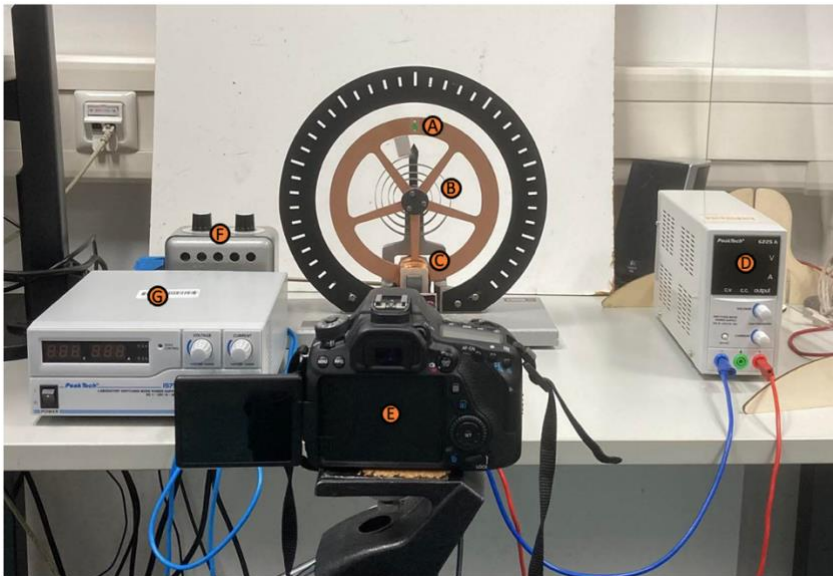
Abb.9 | Mein Versuchsaufbau für Messungen mit dem Pohlschen Resonator
