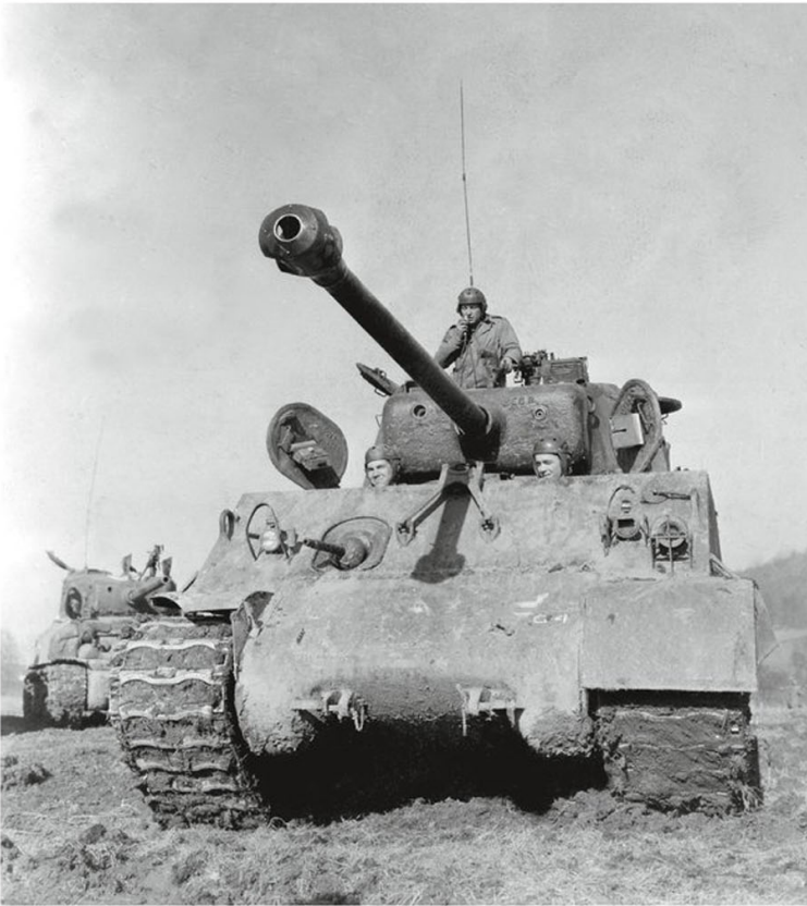
▲ Sherman M4A3E8, dit « Easy Eight », équipé de la nouvelle Horizontal Volute Spring Suspension (ou HVSS) et armé d'un canon de 76 mm. Début 1945, cette version figure déjà en nombre dans les Tank Battalions , mais on y trouve encore quantité de chars équipés des anciens trains de roulement et même quelques-uns toujours armés du canon de 75 qui, bien que peu performant en antichar, tire des obus explosifs dotés d'un meilleur effet de souffle que le 76 mm.
