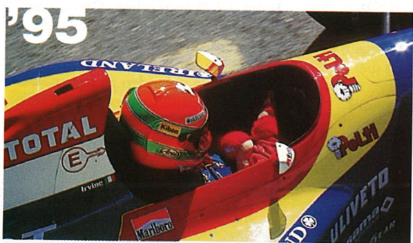
Zwei wichtige Faktoren zur Erhöhung der Sicherheit: Größere Cockpitöffnungen und 75 mm starke, seitliche Polsterungen
