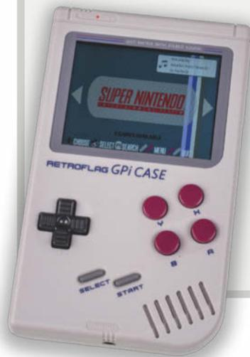
Die Bildqualität des blickwinkelstabilen IPS-Bildschirms überzeugt. Über ein seitliches Rädchen passt man die Leuchtkraft an. Der interne Lautsprecher klingt extrem blechern und der Kopfhörerausgang ist schlecht abgeschirmt; mit empfindlichen In-Ear-Kopfhörern wird man von Störgeräuschen geplagt. Das Steuerkreuz fühlt sich wie beim
