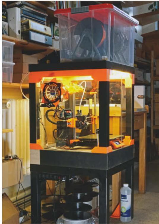
**Der kleine Raspi ist unter dem 3D-Drucker-Gehäuse versteckt. Seine Kamera hängt als kleines Rechteck an der Vorderkante der Seitenscheibe.**
