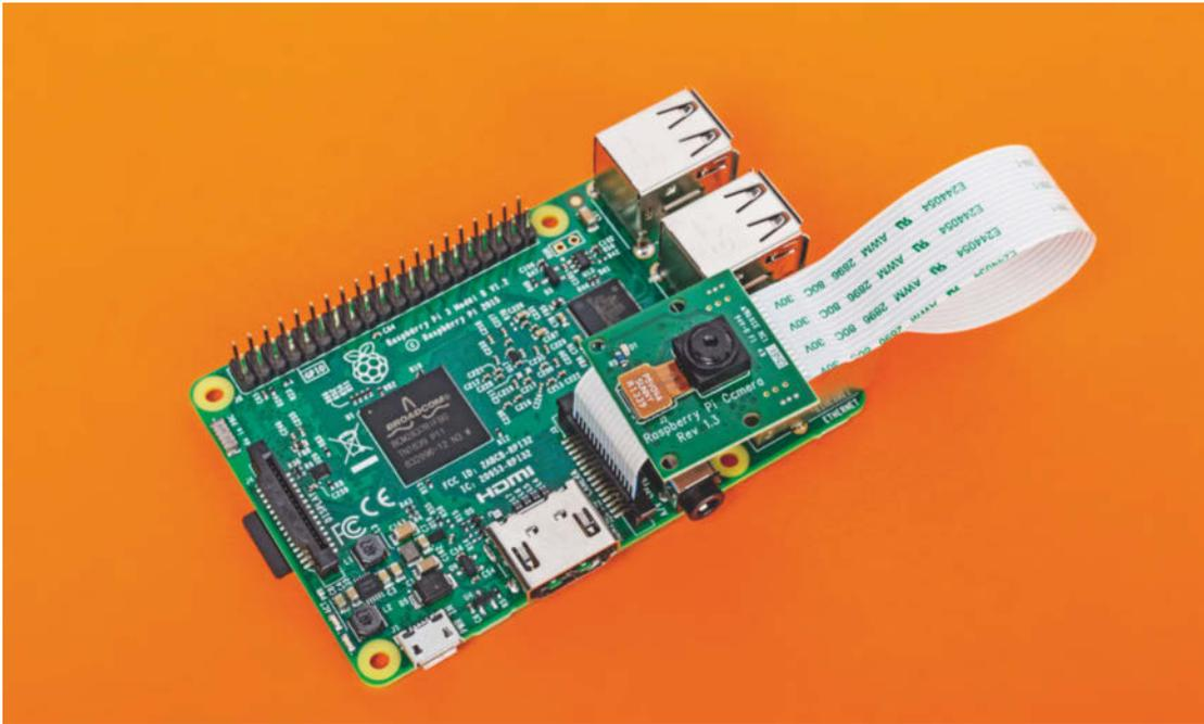
Das mitgelieferte Flachbandkabel der Raspberry-Kamera ist kurz. Ist es für ein Projekt sinnvoll, kann man es durch längere Flachbandkabel austauschen – weil sie ungeschirmt sind, sind Störungen je nach Umgebung möglich.
