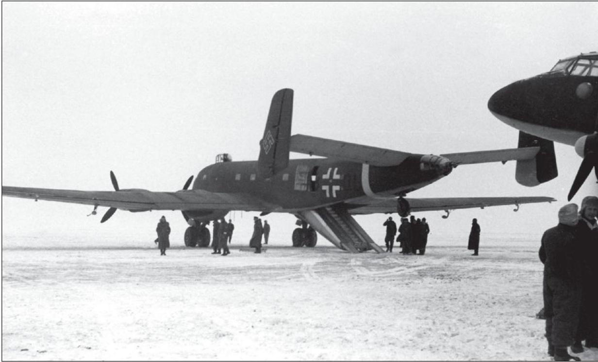
◀ Le Junkers Ju 290 A (SB+QL) envoyé en remplacement du V1 détruit. En s'abaissant, la rampe de chargement ( Trapoklappe ) relevait le fuselage à l'horizontale, ce qui simplifiait considérablement la manutention des véhicules. À droite, le nez d'un Fw 200 du KGr.zbV. 200 sur la piste de Stalino. (ECPA-D)
