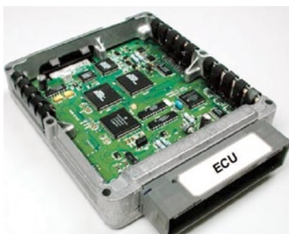
Come appare l'interno di una Engine Control Unit, la "centralina elettronica" di un'autovettura
