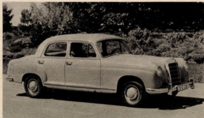
Ez a forma, ez az önhordó pontonkarosszéria egyaránt jellemezte mind az ötvenes, mind a hatvanas években forgalomba került különböző Mercedeseket, amelyeknél már a benzinbefecskendező is megjelent a hathengeres motor mellett, amely azóta nem sokat változott
