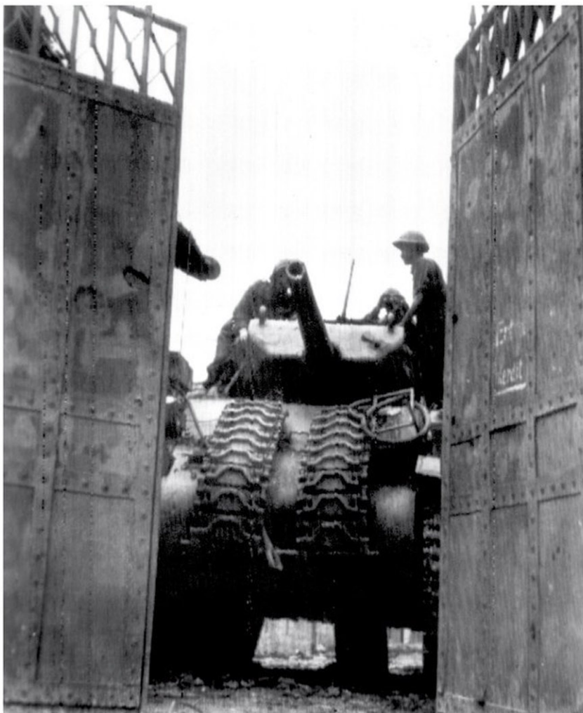
▼ Les portes de Falaise, après s'être entrouvertes, se referment pour ce Tank Destroyer M10 du 6th Royal Canadian Artillery Regiment . Equipé d'un canon de 76 mm en tourelle et non sous casemate comme sur les chasseurs de chars allemands, le M10 d'origine américaine combine mobilité et bonne puissance de feu. Région Basse-Normandie, Archives du Canada
