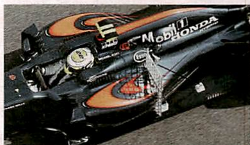
McLaren: Luftstrommessung mit Sensorengitter
