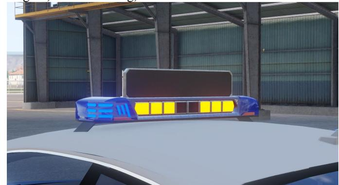
Hinten hat die Anlage ein ausklappbares, bisher noch nicht funktionierendes Matrixschild verbaut, zudem gibt es nun eine Gelblichleiste mit Warnlichtern, welche nach hinten strahlen.
