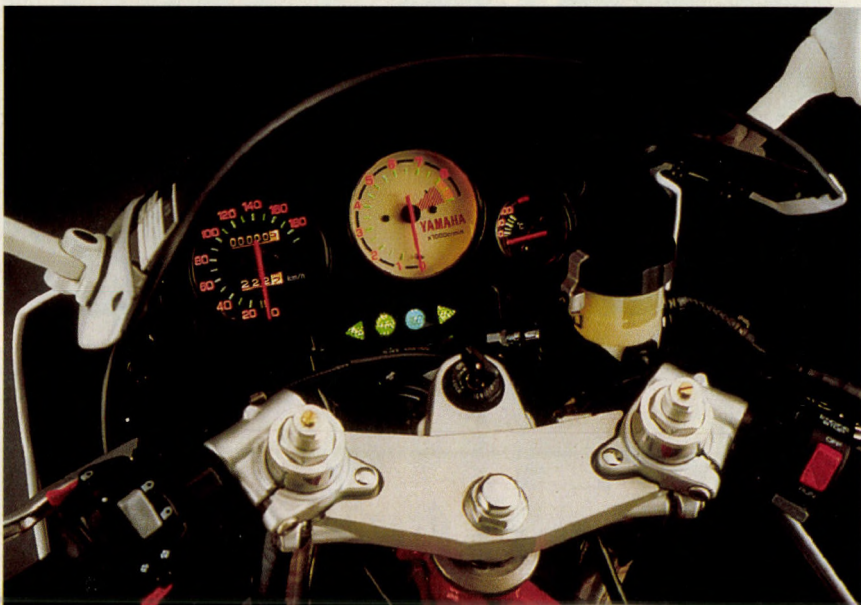
Fordulatszámjelző, sebességmérő és vízhőfokjelző van a fejedom védettségekben
