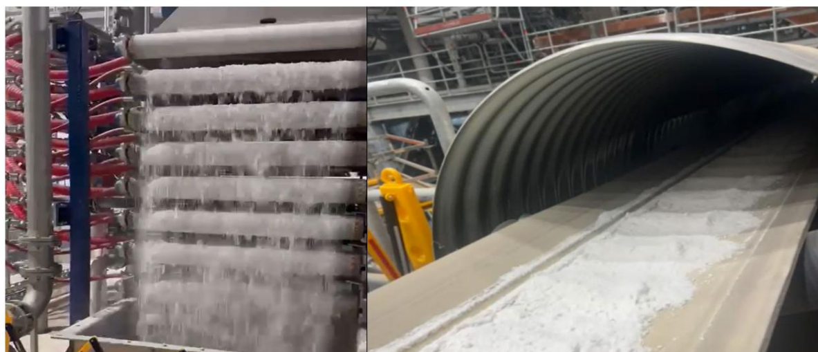
Abbildung 1: Erste Produktion bei Olaroz, Stufe 2 – Filterpresse und Förderband
